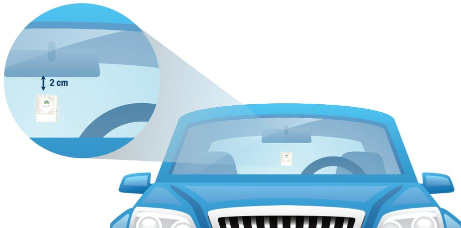
En la mayoría de los vehículos se puede adherir el **TAG PASE** en el interior del parabrisas a 2 cm de distancia por debajo de la base del espejo retrovisor.
