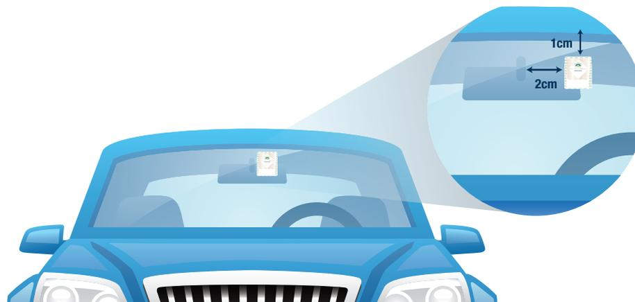
Para los vehículos que se enlistan a continuación, se tiene que adherir el **TAG PASE** en el interior del parabrisas a 2cm de distancia de la parte media del espejo retrovisor, del lado del conductor y 1cm por debajo del borde superior del parabrisas.
